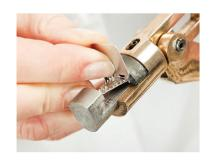
Plombendraht oder -schnur durch die Verplombungsöffnung (nicht im Bild) führen. Die beiden Enden von Draht oder Schnur an der Stelle, an der die Plombe angebracht werden soll, verknoten oder verwinden. Dann die Codierzange mit der Plombe dort anlegen.
