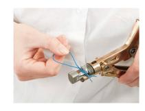
4 Die Zange zusammendrücken. Durch den Mechanismus der Codierzange wird die untere, gezahnte Hälfte der Plombe fest um den Draht gewickelt. Zugleich wird, bei Anwendung eines integrierten Prägestempels, eine Initiale oder ein Logo in die glatte Vorderseite der Plombe geprägt.
